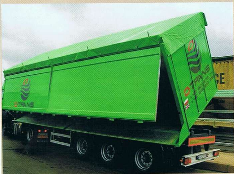
Jedną z ciekawostek z palety producenta jest naczepa samowyładowcza o poj. 43 m 3 z wywrotem jednostronnym, wykonana na zamówienie przewoźnika transportującego kisonkę kukurydzy dla biogazowni. Z lewej strony aluminiowej skrzyni zamontowano dwie burty, przy czym położona wyżej jest otwierana do góry, a druga do dołu. Dolna burta jest otwierana hydraulicznie i blokowana przy wysypie.
