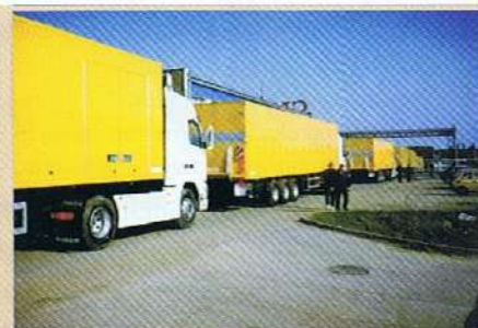
W 1997 r. dla poczty ukraińskiej wykonano 12 naczep z nadwoziem furgonowym z paneli aluminiowych i podwójnymi drzwiami – do transportu paczek.
