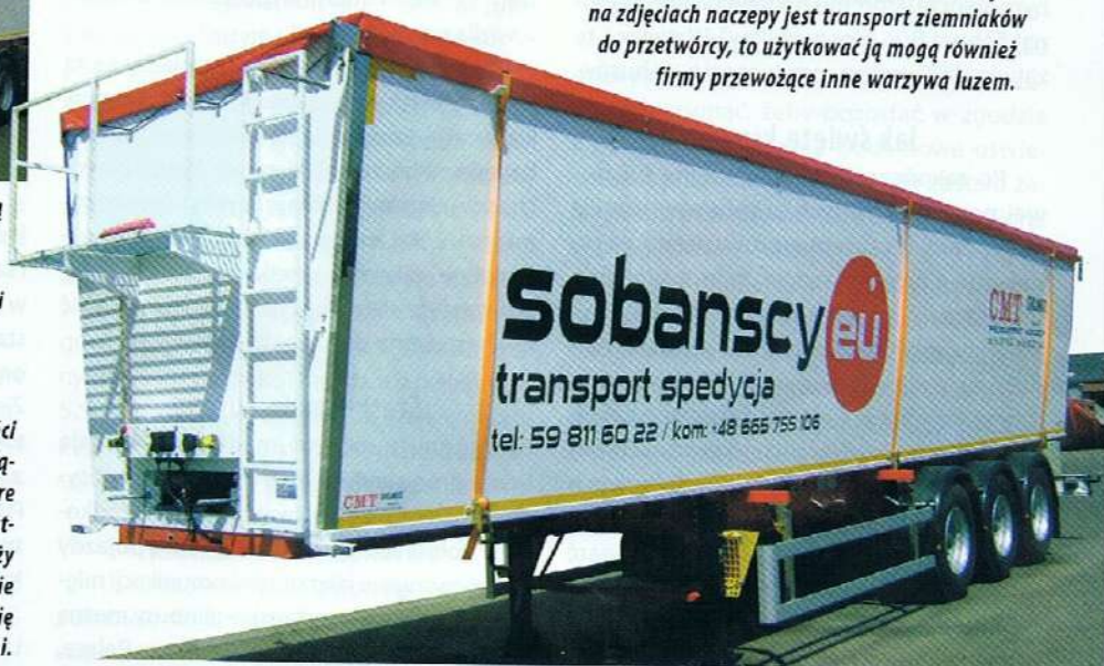
Tylna i przednia ściana naczepy wyposażone są w drabinki i podesty robocze – można wspiąć się np. w celu naciągnięcia plandeki. Kontury pojazdu, zgodnie z nowymi wymogami unijnymi, oklejono taśmą odblaskową.
