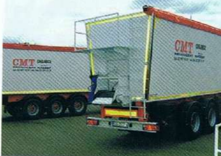
Tylna i przednia ściana naczepy wyposażone są w drabinki i podesty robocze – można wspiąć się np. w celu naciągnięcia plandeki. Kontury pojazdu, zgodnie z nowymi wymogami unijnymi, oklejono taśmą odblaskową.
