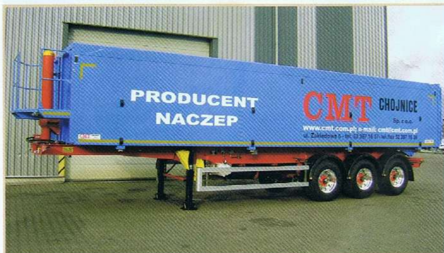
Od wielu lat naczepy samowyładowcze są sztandarowym produktem CMT, sprzedawanym w największej liczbie egzemplarzy, cenionym przez użytkowników za wysoką wytrzymałość przy zachowaniu ograniczonej masy własnej i dużej ładowności. Na zdjęciu – naczepa ze skrzynią z paneli aluminiowych. Dla ograniczenia masy własnej zastosowano m.in. obręcze kół z lekkich stopów.
